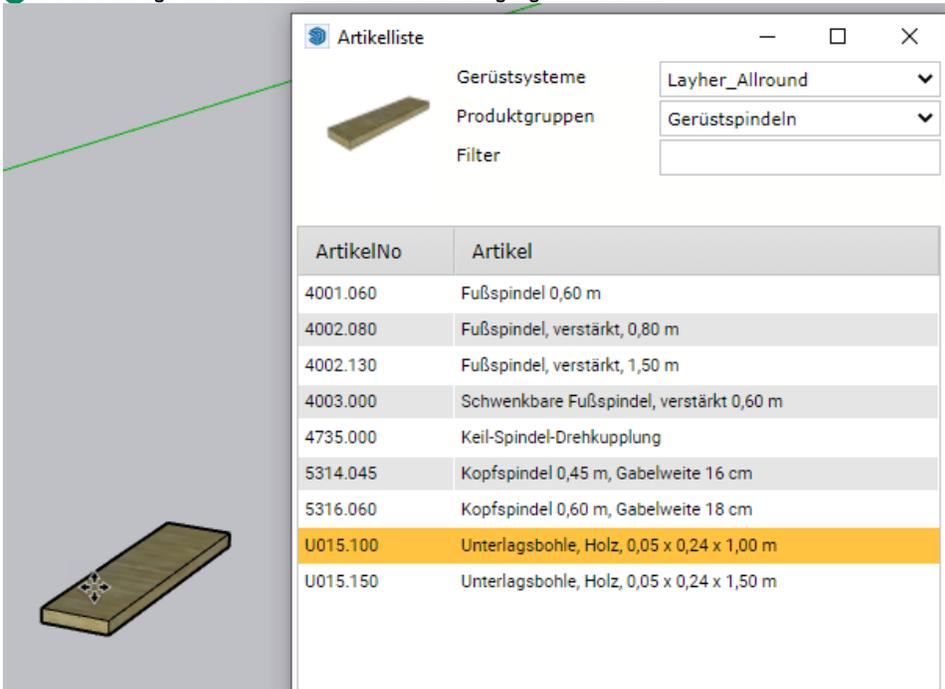
4. Klicken Sie mit der linken Maustaste, um das Bauteil an einer beliebigen Stelle abzusetzen.
